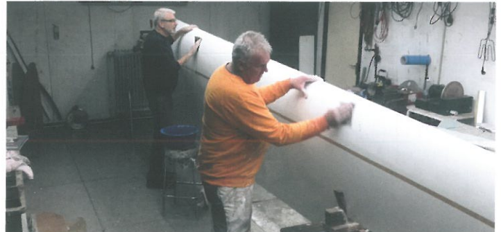
Der Tragflügel des Motorseglers wird in der Vereinswerkstatt teilweise neu lackiert. Thomas Brambosch und Jens von Nethen schleifen die alte Farbe herunter.
